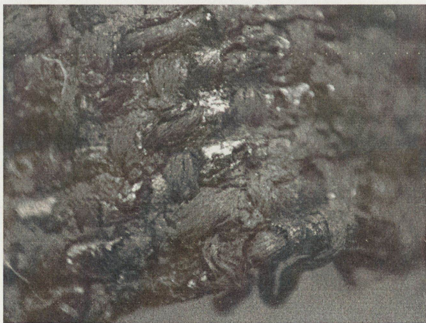
Обр. 3. Структура на текстила – основни нишки и сърмен вътък. На места металната обвивка на сърмените нишки е опадала и се вижда коприненото ядро (x30).
